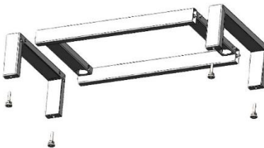
Рис. 1. Сборка высокого каркаса
